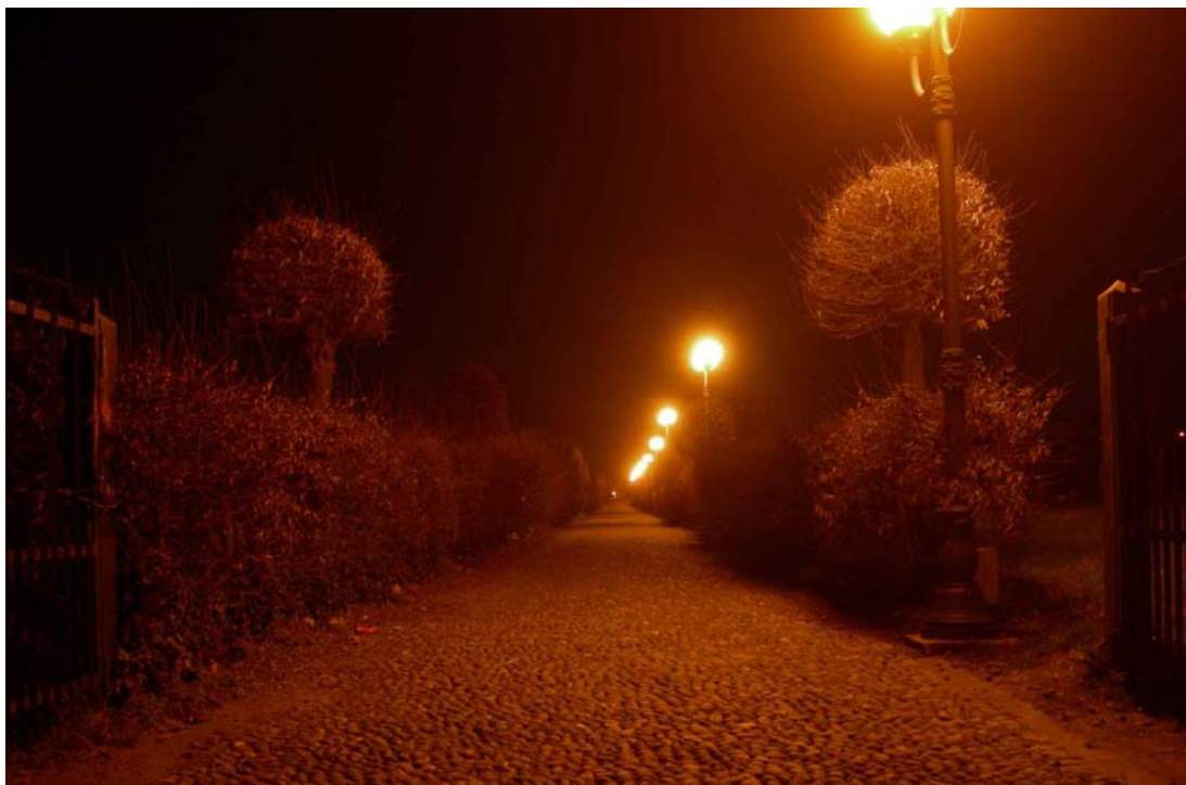
Via Della Vigna Chiusa: globi diffondenti non conformi alla normativa regionale vigente. Risulta evidente dalla percezione fotografica notturna la dispersione del flusso luminoso verso la volta celeste.
