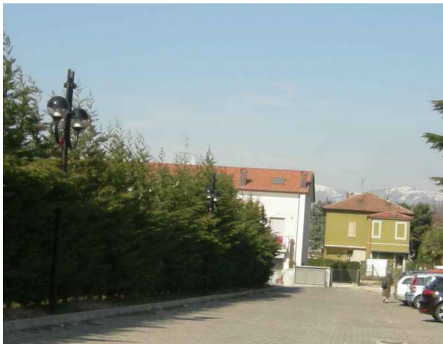
Parcheggio all'incrocio della S.P. 56 con la S.P. 54: globi schermati compatibili con le leggi regionali vigenti, ma equipaggiati con sorgenti ai vapori di mercurio non conformi alla L.R. 17/2000 e alla L.R. 38/2004
