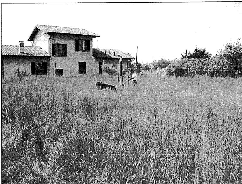
**FIG. 15** Esecuzione prova penetrometrica dinamica scpt
